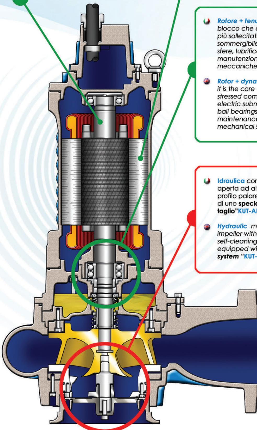
● **Rotore + tenute dinamiche** è il blocco che contiene i componenti più sollecitati dell'elettropompa sommersibile; cuscinetti radiali a sfere, lubrificati a vita, esenti da manutenzione; tenute meccaniche doppie a norme DIN.
